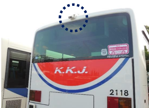
②バックカメラの設置場所（車両最後部）
