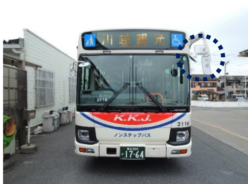
①補助ミラーの設置状況（写真左：ミラーの設置場所、右：車内から見た様子）
