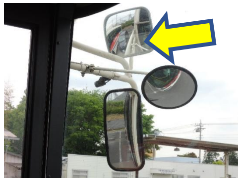
①補助ミラーの設置状況（写真左：ミラーの設置場所、右：車内から見た様子）
