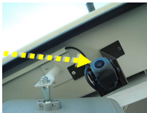
④ドライブレコーダー装置（黄色の丸印箇所にカメラを備えております）
