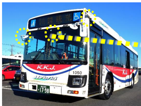
④ドライブレコーダー装置（黄色の丸印箇所にカメラを備えております）
