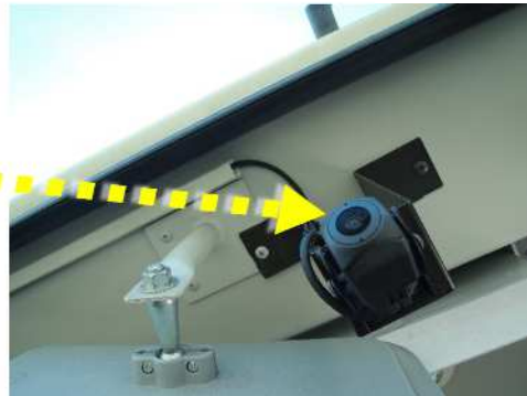
⑤ドライブレコーダー装置（黄色の丸印箇所カメラを備えております）
