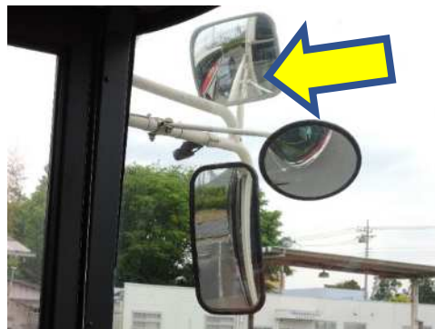
②補助ミラーの設置状況（写真左：ミラーの設置場所、右：車内から見た様子）
