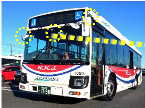
⑤ドライブレコーダー装置（黄色の丸印箇所カメラを備えております）
