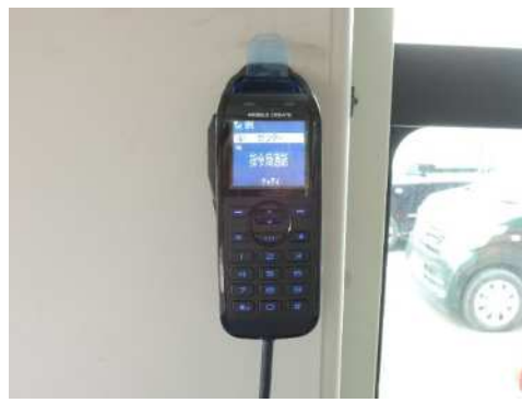
⑦全車両に I P 無線を設置し、バスの運行状況を把握できるシステムを構築しています。
