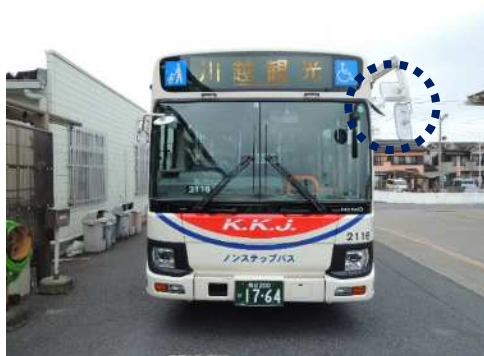
②補助ミラーの設置状況（写真左：ミラーの設置場所、右：車内から見た様子）
