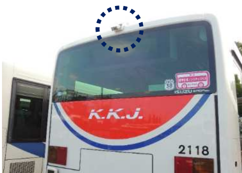
②バックカメラの設置場所（車両最後部）
